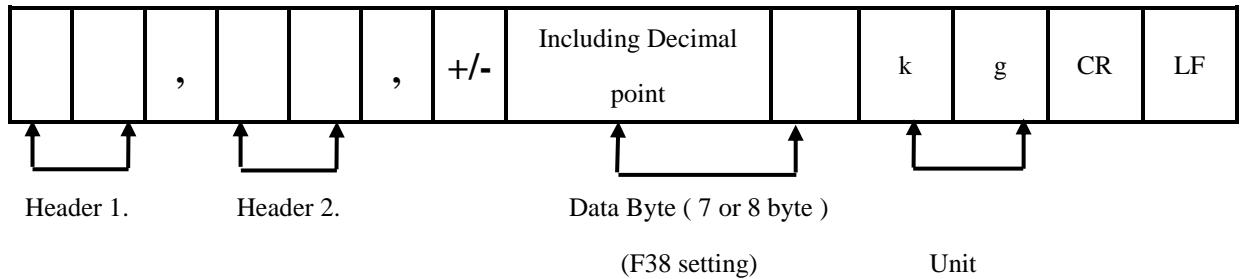
① Header 1. : OL : Over Load, Under Load
