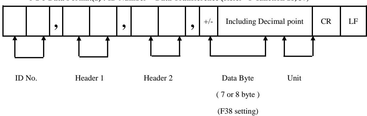
① Header 1. : OL : Over Load, Under Load
